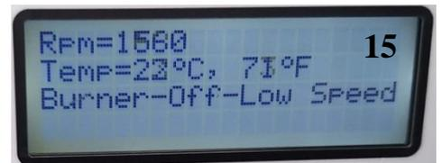
15. **ATTENTION:** lorsque le brûleur a démarré, il est important que la vitesse du moteur soit réglée à pleine vitesse. Si ce n'est pas dans les 10 secondes, le brûleur s'éteindra et l'écran affichera « Burner-Off-Low Speed ».
