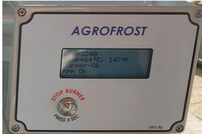
Ogni macchina viene inoltre fornita con una scatola di controllo superiore aggiuntiva per l'avvio manuale. Se si verifica un problema con il sistema di avvio automatico, è possibile sostituire la scatola di controllo superiore in modo che la macchina possa ancora essere utilizzata in modalità manuale.
