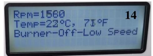
14. **ATTENZIONE:** se per qualche motivo la velocità del motore è troppo bassa, il bruciatore si spegnerà e lo schermo mostrerà "Burner-Off-Low Speed (*Bruciatore spento – Bassa velocità*)".
