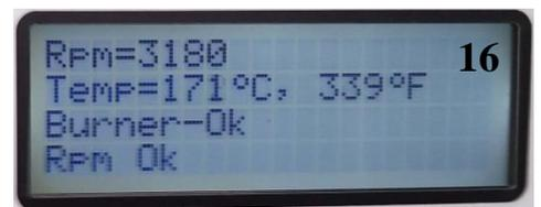
16. Una volta che la macchina è in funzione, è possibile attivare l'allarme acustico, utilizzando l'interruttore (G) 'Temp Alarm ON-OFF' sulla scatola di controllo. L'allarme suonerà quando la temperatura è troppo bassa (< 55 °C) o troppo alta (> 130 °C). Non accenderlo prima che la temperatura abbia raggiunto la sua normale temperatura di funzionamento, altrimenti l'allarme suonerà immediatamente.
