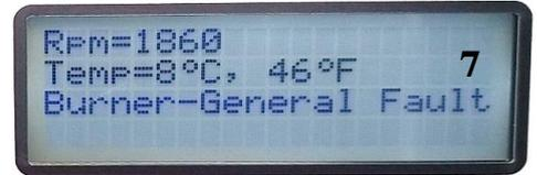
8. Ricominciare dal punto 3. Quando il motore va a tutto gas, controllare la pressione sul secondo regolatore di pressione (E). Probabilmente la pressione del gas è troppo bassa e non c'è abbastanza alimentazione di gas per accendere il bruciatore. Mentre il bruciatore si accende, la pressione del gas dovrebbe essere di almeno 0,5 bar. In caso contrario, regolare la pressione.
