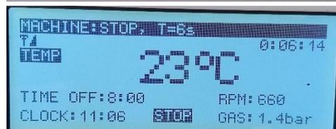
\*\*\* = se la macchina non si avvia, probabilmente la pressione del gas è troppo bassa e la temperatura del bruciatore non raggiunge i 40 °C dopo 1 minuto. Controllare la pressione del gas sul secondo manometro del gas all'avvio della macchina. Se necessario, regolare la pressione.
