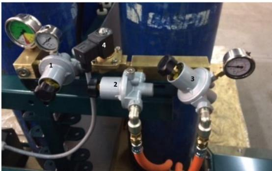
7. Der Arbeitsdruck des Gases soll jetzt mit Druckregler (3) geändert werden auf solche Weise, dass der Thermometer 80°C bis 90°C anzeigt, die Betriebstemperatur die man während die Arbeit mit dem Frostbuster behalten soll. Der Thermometer wird während die erste 20 Sekunden fast nicht bewegen, und dann steigt er schrittweise bis zum 60-70°C.
