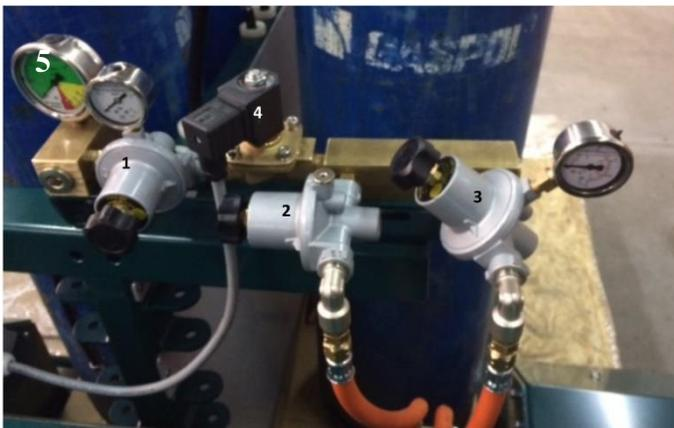
1. erster Druckregler: zur Einstellung des Grundgasdrucks. Verwenden Sie diese nur bei sehr niedrigen Temperaturen (-5 bis -6 °C) und wenn die Temperatur des Brenners unter 80 °C sinkt. In diesem Fall können Sie hier den Druck erhöhen.
