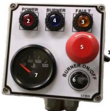
3. Setzen Sie den Hauptschalter (1) auf Stand „ON“, oder nach oben. Die rote Kontrolllampe (2) geht an. Wenn diese Lampe nicht angeht, prüfen Sie dann den Stecker des Schaltbrettes des Traktors.
