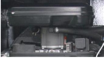
Nettoyer le filtre d'air avec de l'air comprimé tous les 75 heures d'opération (ou chaque année si le machine n'a pas travaillé 75 heures).
