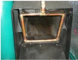
Le tube diffuseur (GC20) : ce tube diffuseur garantit un flux d'air horizontal. C'est impossible de protéger ce tube sans influencer l'opération initiale de la machine. Pour cela, un risque résiduel reste.
