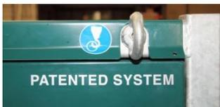
Œillet de fixation/levage : il faut utiliser ces œillets pour fixer la machine pendant le transport. Pour lever la machine, il faut utiliser tous les quatre œillets de la machine.
