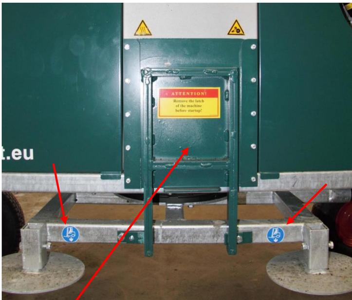
**GC20** : la plaque d'obstruction et de blocage située à la sortie du ventilateur évite que la machine puisse se tourner pendant le transport. **Cette plaque doit toujours être montée pendant chaque transport/déplacement de la machine.**
