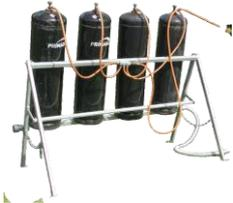
Bouteilles de gaz : la machine utilise du gaz propane pour chauffer l'air. Les bouteilles doivent être installées sur le support qui est livré avec le FrostGuard. C'est important que le support soit connecté avec le tuyau d'échappement de la machine par le tube flexible.
