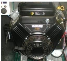
Moteur : le moteur fonctionne avec du gaz propane et entraîne le ventilateur. Le moteur est refroidi par l'air que est aspiré par le ventilateur. Pour assurer le refroidissement, toutes les portes doivent être fermées pendant le fonctionnement du moteur.
